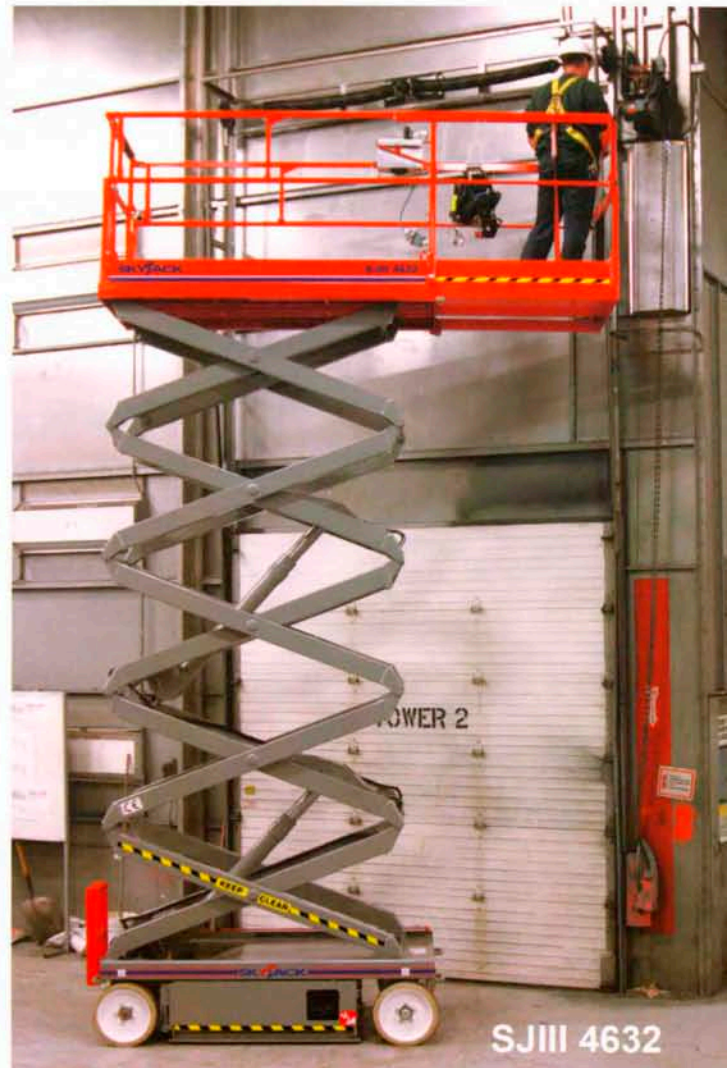
Conventional-Serie mit hydraulischem Hinterradantrieb und variabler Geschwindigkeitskontrolle
