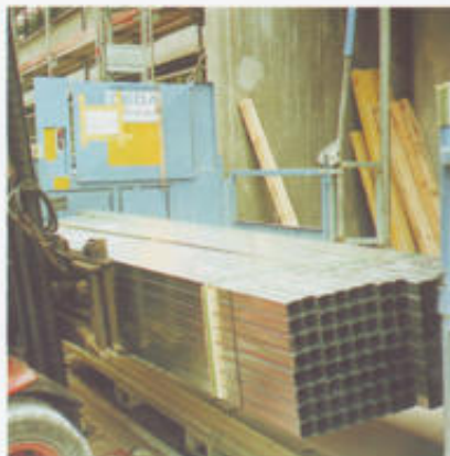
Problemloses Beladen von langen, sperrigen Gütern. Bühnenvariante „I“, Abmessungen 1,65 x 4,35 m.
